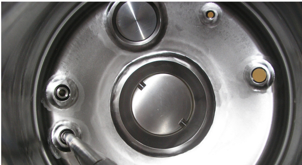
Vista interior: válvula de disco y conexión accesorios
